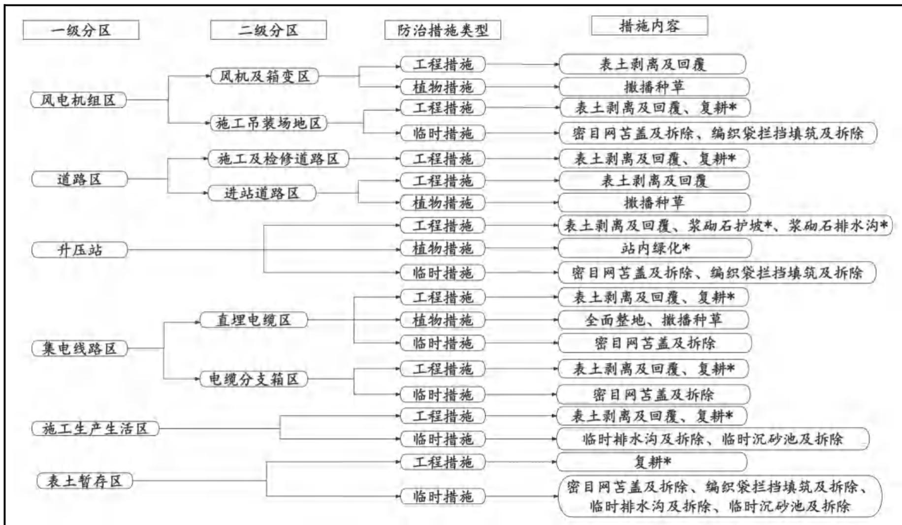
图 5.2-1 水土流失防治措施体系框图 (\*为主体已有)
